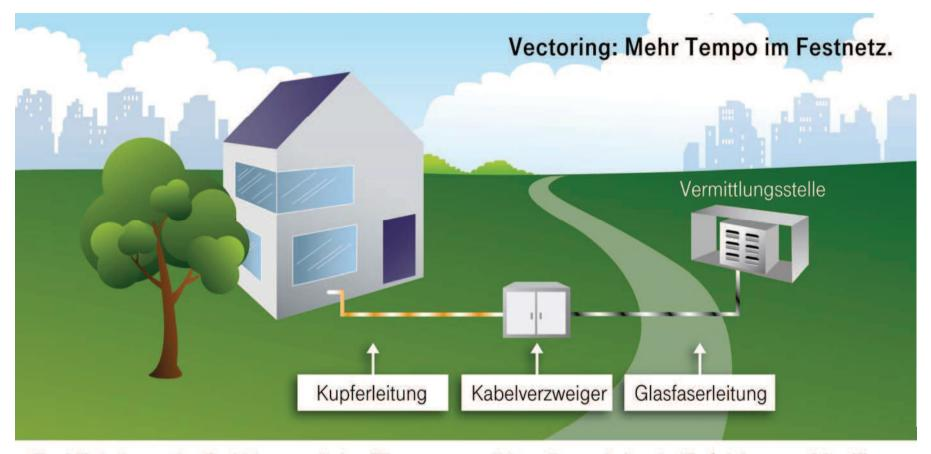
Durch Vectoring werden die elektromagnetischen Störungen ausgeglichen, die es zwischen den Kupferleitungen auf dem Weg in die Haushalte gibt. Das ermöglicht mit Geschwindigkeiten von bis zu 100 Mbit/s deutlich schnellere Datenübertragungen. Die Technik dafür wird in den Kabelverzweigern installiert.
